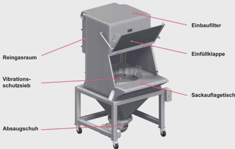
Abb.: Sackentleerstation mit Einbaufilter und Vibrationsschutzsieb sowie Absaugschuh zur Anbindung an eine pneumatische Förderanlage
