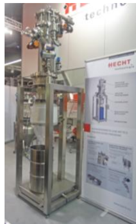
Abb.: Anlage zur Kleingebindebefüllung inkl. PCC mit Doppelfilter, Vakuum-Probenehmer, Vibrations-Dosierklappe sowie Endlosfolien-Befüllkopf mit integriertem Entstaubungsfilter
