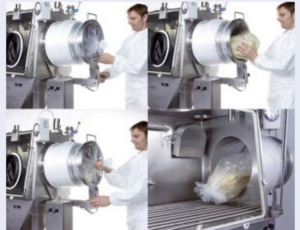
Kontaminationsfreies Einschleusen der Säcke in den Isolator
