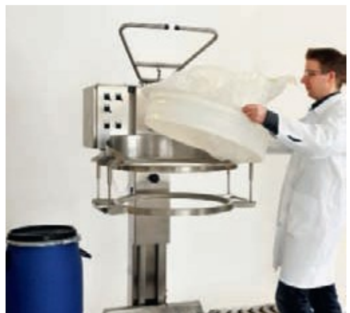
Bild 2: Bediener beim Einsatz der Einweg-Schutzfolie in das Gestell des EPS.
