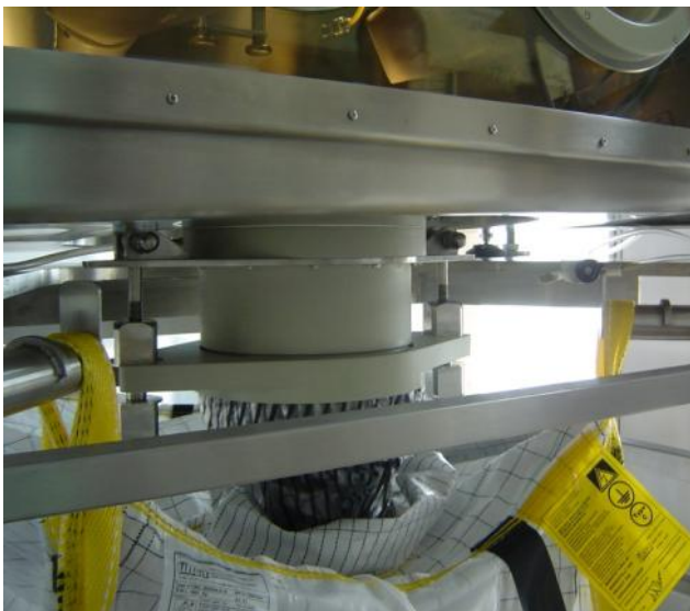
Abb.: Big Bag zur Befüllung an Isolator angeschlossen
